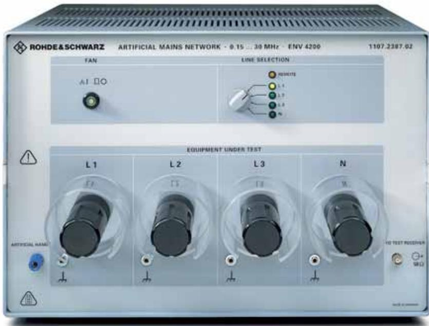
Die Netznachbildung R&S ENV 4200 dient zur Messung von Funkstörspannungen auf Netzanschlüssen von Prüflingen mit sehr hoher Stromaufnahme. Sie ist mit eisenlosen Induktivitäten aufgebaut und enthält eine Handnachbildung.
